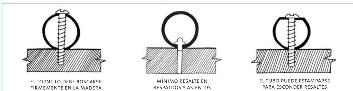
Se recomienda al fabricante realizar las perforaciones de los elementos metálicos consultando el estampado como técnica, ya que posibilita simultáneamente, mediante una matriz sencilla, generar rebajes en el tubo para dar cabida a la cabeza del tornillo o remache, según sea el caso, y no provocar molestias al usuario con sus resaltes naturales.
